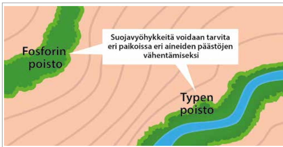
Kuva 1.1.2. USA:ssa opastetaan perustamaan fosforin huuhtoutumisen vähentämiseen tähtäävät suojavyöhykkeet pellolle ja typen poistoon tähtäävät suojavyöhykkeet vesistöjen varrelle. Piiros: Toinen Keksi Oy, alkuperäinen kuva: Bentrup (2008).
