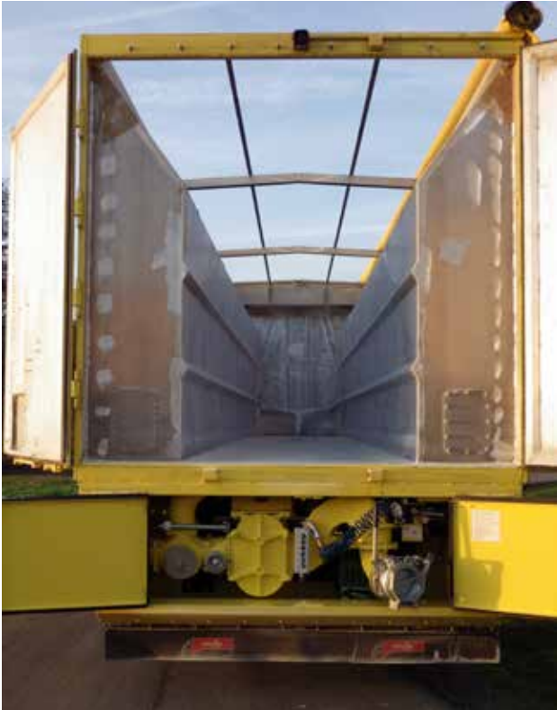
Kuva 2.2.2. GS Agrin yhdistelmäauto, jolla voi kuljettaa sekä lietalantaa että rehua. Kuva: Katharina Hesselbarth, DLG-Mitteilungen
