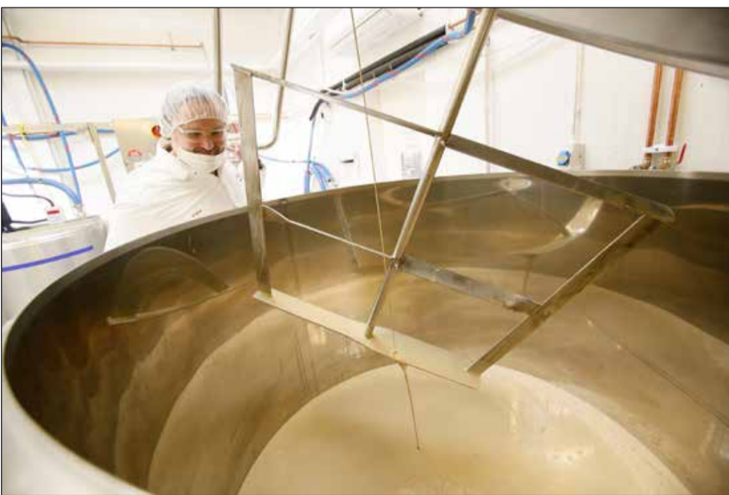
Horst Neumann kurkistaa kypsytystankkiin ja seuraa, miten lakritsijäätelön pastörointi ja jäähditys etenevät.
