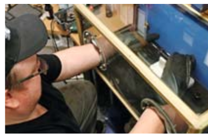
Kiikari kuivataan typpikaapissa, missä myös puhdistetut linssit kiinnitetään. Kosteus pysyy käytössäkin poissa.
