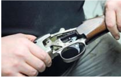
Haulikko puretaan osiin ja kaikkien osien toiminta tarkistetaan.
