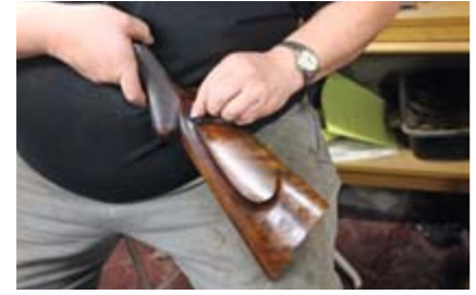
Haulikon perä puhdistetaan ja öljytään huolella. Öljy tukkii mahdolliset naarmut ja pinnoitteen halkeamat.
