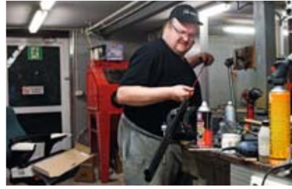
Haulikon piippu rassataan puhtaaksi muun muassa palojäljistä.
