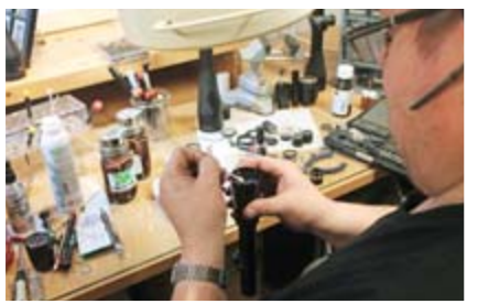
Kiikarin linssien puhdistus ja kiikarin kokoaminen vaativat tarkkuutta. Ja kynsilakkaa, jolla kiinnitysruuvit lukitaan.
