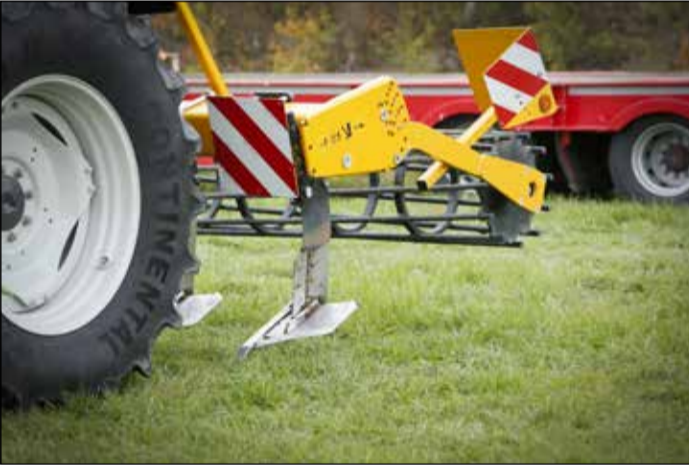
Jankkurin terä on maan pinnan suuntainen. Se nostaa pohjamaata tiivistyneen kerroksen alapuolelta hieman ylöspäin, mikä rikkoو maan rakennetta.
