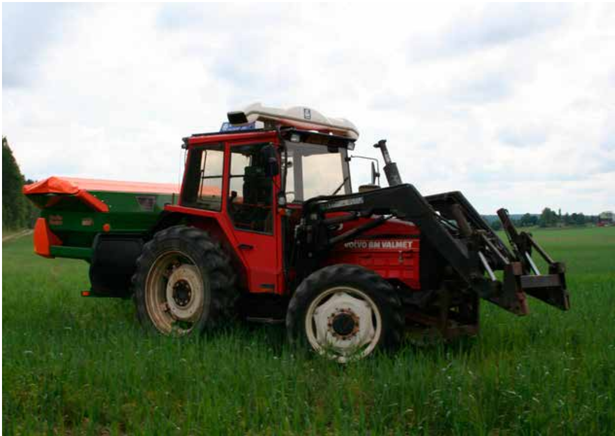
Kuva 1.4.1. Toivon tilalla Salossa typpisensoria käytetään apuna typpilannoituksen tarpeen mittaamisessa. Typpisensori on valkoinen laite traktorin katolla. Kuva: Eija Hagelberg
